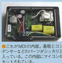
●これがMDIの内部。基板とコンデンサーなどのパーツがシッカリと入っている。この内部にマイコンがセットされている。
