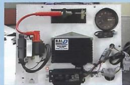
●これは、MDIシステムを使って、火花の状態を目で見えるようにしたものだ。フルトラと切り替えながら、回転数を変化させる。
